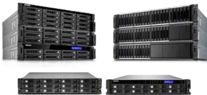
QNAP détecte les pannes de lecteur possibles et migre les données vers un disque de rechange sain. Le double système d'exploitation embarqué dans l'architecture DOM garantit que le système démarrera même si l'un des systèmes est en panne. Les ports LAN Gigabit doubles peuvent aussi être configurés pour le basculement, ce qui permet au NAS de compenser la panne d'un port réseau et de continuer à proposer des services.
